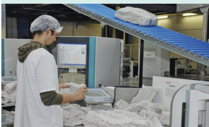
Mitarbeiter von Clean+ in der Leverkusener Wäscherei bei der Qualitätskontrolle. Oben im Bild: vollautomatisch verpackte Wischmopps.
